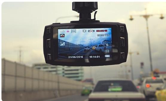
普段は位置情報を閉域網経由で安全に収集、急制動や衝突時のみ映像をアップロード
